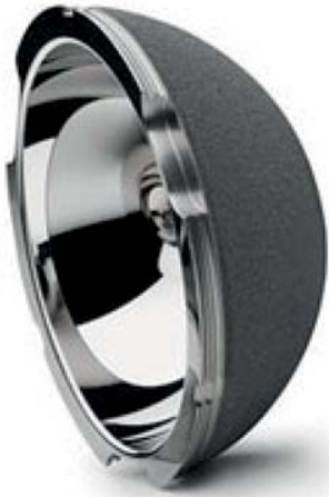
Рисунок 37. Чашка M2a-Magnum фирмы Biomet с внутренней полированной частью. Такой чашке не нужен вкладыш, и благодаря малой толщине возможно применение головки большого диаметра.
