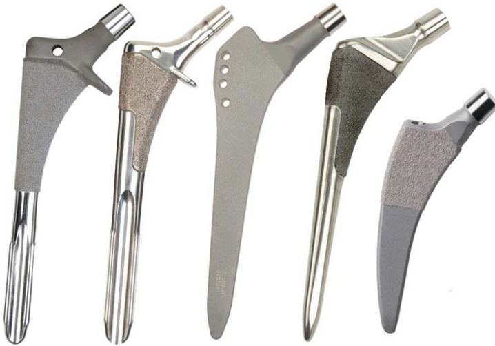
Рисунок 17. Варианты поверхностей ножек эндопротезов на примере продукции фирмы Zimmer. Слева направо: ножка VerSys Beaded MidCoat с покрытием из спрессованных шариков; ножка VerSys Fiber Metal MidCoat с покрытием из спрессованных волокон металла; ножка Alloclassic с шероховатой поверхностью, полученной после пескоструйной обработки; ножка Trabecular Metal Primary Hip Stem с поверхностью из трабекулярного металла; короткая ножка Fitmore с плазменным напылением титанового сплава.
