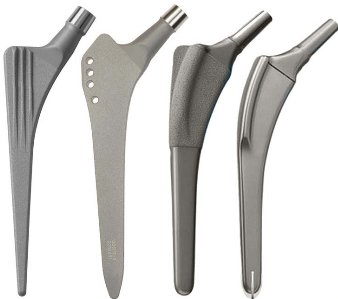
Рисунок 18. Варианты формы ножки. Слева направо: ножка CLS Spotorno фирмы Zimmer с тремя продольными ребрами; ножка Alloclassic фирмы Zimmer с отверстиями; ножка Excia фирмы Aesculap с дугообразным ребром с пористым покрытием, ножка Excia фирмы Aesculap с дугообразным ребром с плазменным напылением.
