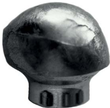
Рисунок 45. Головка из обычной медицинской нержавеющей стали за два года практически полностью истерлась, что потребовало ее замены. Сейчас такие головки уже не выпускаются.
