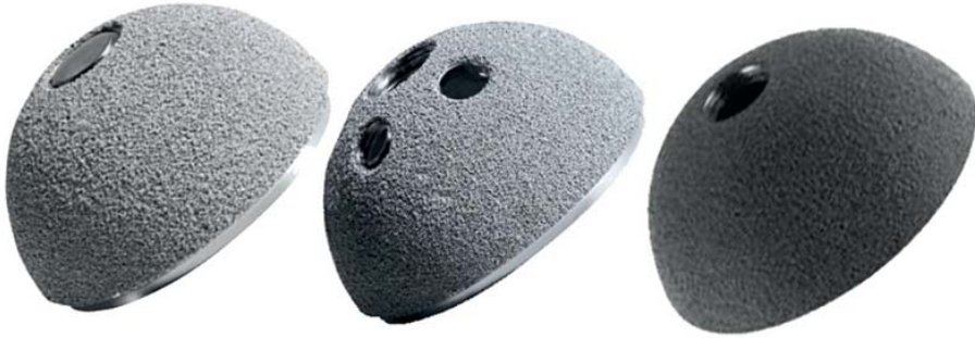
Рисунок 35. Варианты наружного покрытия бесцементных чашек эндопротеза тазобедренного сустава на примере чашек Pinnacle фирмы DePuy (концерн Johnson & Johnson). Слева — чашка с покрытием Porocoat, которое представляет собой слой спрессованных маленьких шариков из чистого титана; в центре — чашка с покрытием GRIPTION, которое разработано на основе покрытия Porocoat и отличается от него меньшим размером пор и большим коэффициентом трения; справа — чашка с покрытием Duofix, которое представляет собой комбинацию покрытия Porocoat с плазменным напылением гидроксиапатита, стимулирующего врастание кости.
